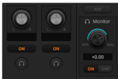
Ручка и кнопки в окне Monitor позволяют устанавливать громкость и вести мониторинг отдельных аудиоканалов
