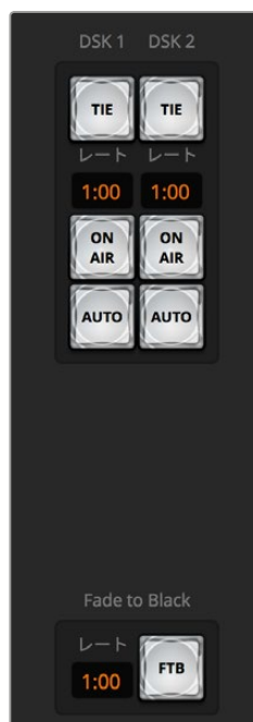
ダウンストリームキーヤーとフェード・トゥ・ブラック
