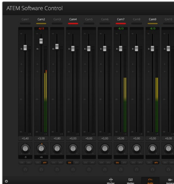
Der Audiomixer zeigt Tally-Rotlichter für alle aktuell on Air befindlichen Audioquellen an und bei aktiviertem AFV zusätzlich Audiopegel, Lautstärke sowie Schaltflächen zur Auswahl des zu benutzenden Tons
