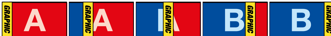
グラフィック・ワイプ・トランジションのプログラム出力の一例
