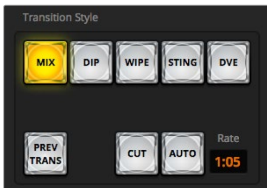
Кнопка Auto находится в блоке Transition Style
