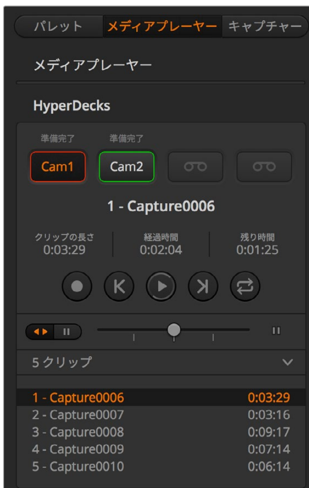
HyperDecksパレットのボタンを使用して4台までのHyperDeckを選択
