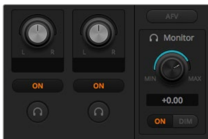
모니터 볼륨 노브와 버튼으로 오디오 레벨을 개별적으로 설정하고 오디오 출력을 단일 모니터링할 수 있습니다.
