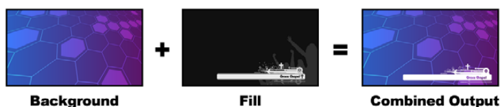
Совмещение фона и вырезающего/заполняющего сигналов при яркостном кеинге
