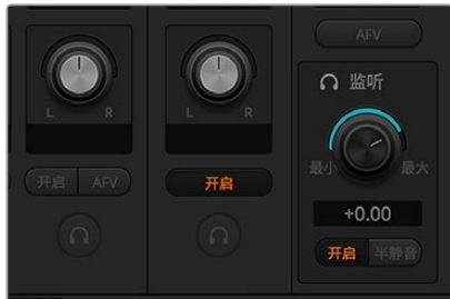
监听音量旋钮和按钮可设置独立音频电平并可在音频输出上进行单独监听。
