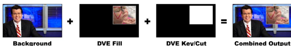
Combiner un arrière-plan avec une source de remplissage DVE et une source de découpe DVE
