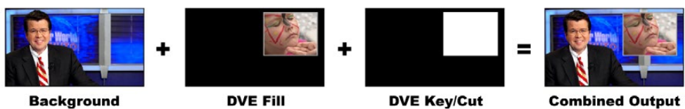
Combinación de la imagen de fondo, la imagen superpuesta y la máscara
