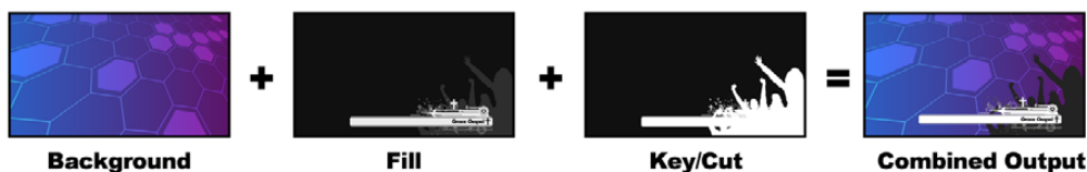
Combinación del fondo, el canal alfa y la señal principal en una composición lineal
