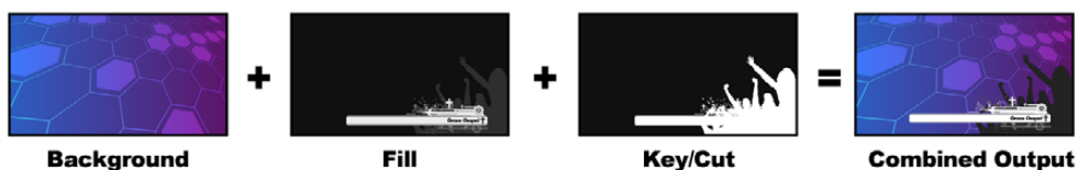
Kombinieren eines Füll- und Stanzsignals in Form eines Linear-Key
