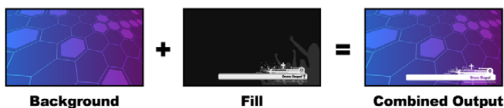
Combinación del fondo y el canal alfa / señal principal en una composición por luminancia
