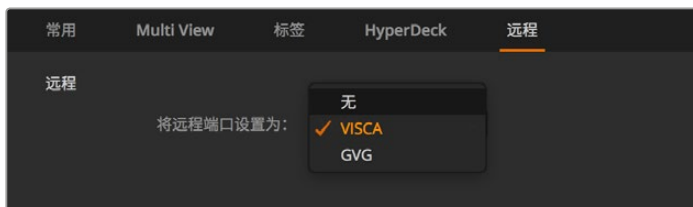
将RS-422远程端口设为“无”、“VISCA”或“GVG”
