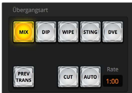
Die Übergangsschaltfläche AUTO gehört zur Übergangsart-Gruppe
