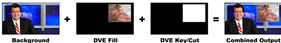
バックグラウンド、DVEフィル、DVEキー/カットの結合
