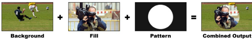
Объединение фона и заполняющего сигнала при шаблонном наложении
