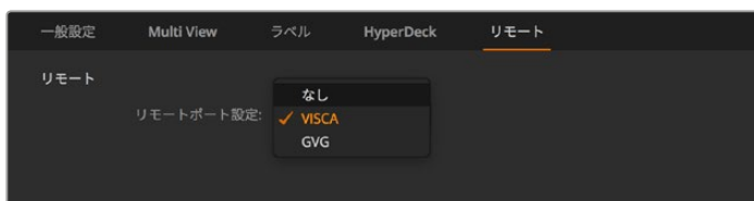
RS-422リモートポートを「なし」、「VISCA」、「GVG」に設定
