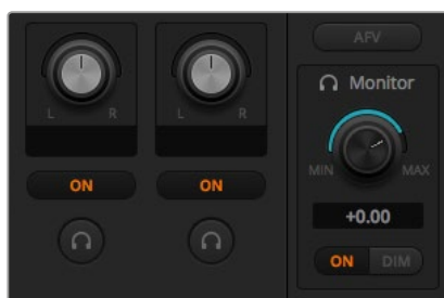
モニターボリュームノブとボタンでオーディオレベルを別々に設定して、オーディオ出力でソロモニタリングできます。
