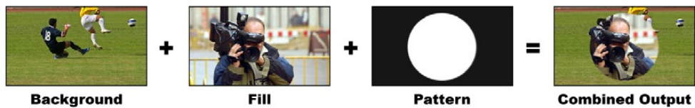
Combinación del fondo con la imagen superpuesta y la forma geométrica
