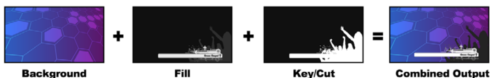
Совмещение фона, заполняющего и вырезающего сигналов при линейном кеинге
