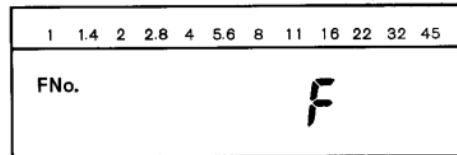
6. Le flash est déclenché par le bouton de test "open flash" et le posemètre indique le nombre f en digital.
