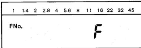
6. Dispare el flash presionando su botón de flash con obturador abierto/prueba. El medidor mostrará la indicación del número f en su indicador de cristal líquido.
