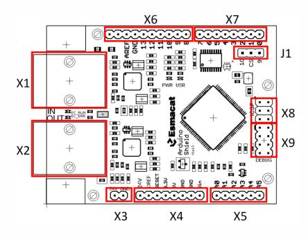
FIGURE 3. CONNECTORS AND JUMPER OF EASE
